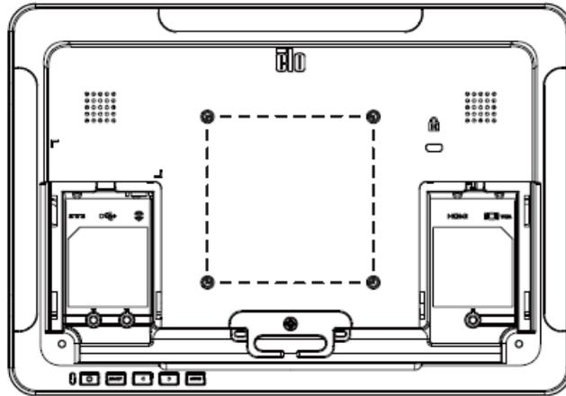
1502L & 2002L 觸摸顯示器在顯示器的背面，提供適合 M4 螺絲的四孔 75x75mm 和 100x100mm 安裝樣式。使用 Phillips 螺絲刀卸下支架，以便露出該安裝面。符合 VESA FDMI 標準的安裝編碼為：VESA MIS-B, 75, C 和 VESA MIS-B, 100, C。
