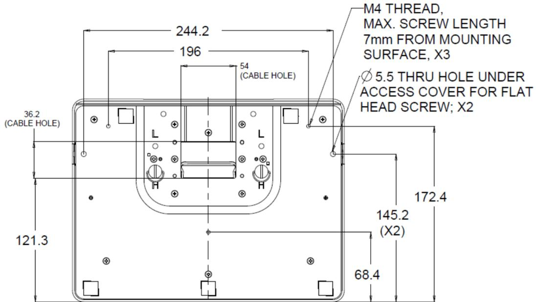
2002L 觸控顯示器的螺孔位於底座的底部，可用於安裝或固定。
